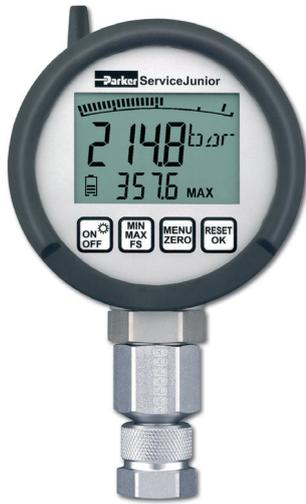
El ServiceJunior inalámbrico de la familia de productos Parker SensoControl le permite registrar cómodamente los valores de presión tomados desde uno o varios puntos de medición en su máquina o instalación. Los datos medidos se transmiten a un PC a una distancia de hasta 150 metros.
