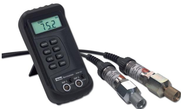
El Serviceman tiene 2 entradas para sensores. Esto permite medir la presión diferencial pulsando una sola tecla. Los valores reales y ajustados se pueden comparar de forma rápida y fácil.
