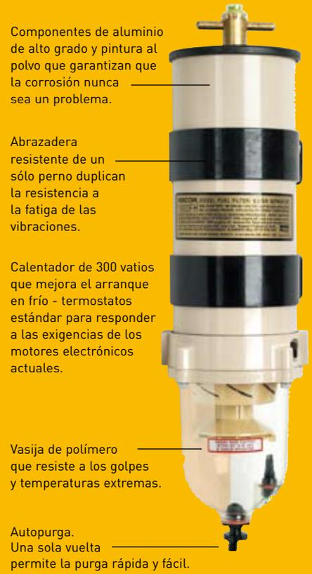
Aquabloc media rechaza el agua y mantiene los motores protegidos del agua, la corrosión y la contaminación.
